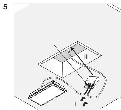
5 Подключите световой модуль (поз. 2) к блоку питания (поз. 3). Блок питания к электросети (см. схему подключения), а затем установите его за гипсокартонный потолок.
